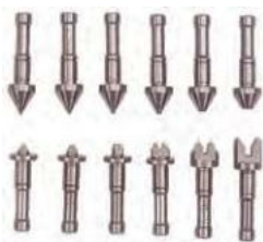
Provedení výměnných doteků/vřeten v odpovídajících párech
